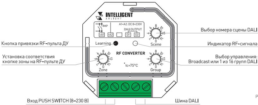
Рисунок 1. Органы управления и подключения конвертера.
