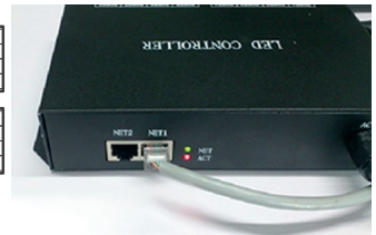
Рис. 2. Подключение контроллера HX-801RC к мастер-контроллеру или компьютеру.
